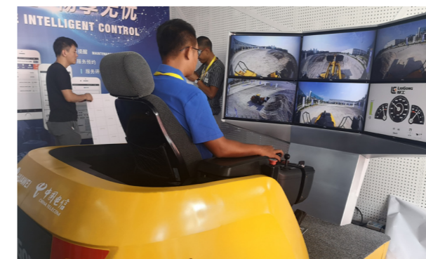
2019 年 9 月 4 日，工程师在北京的操作台上遥控 2000 公里外柳工国际工业园的装载机进行作业
